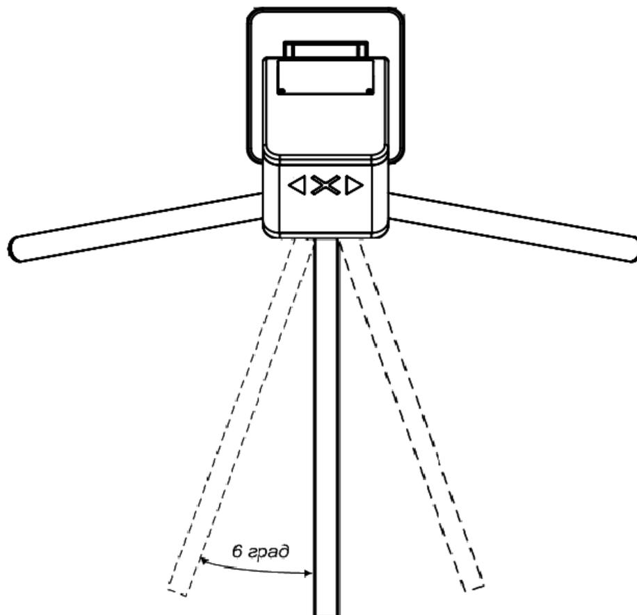
Рисунок 2 – Возможный свободный ход планки в режиме «STOP»
