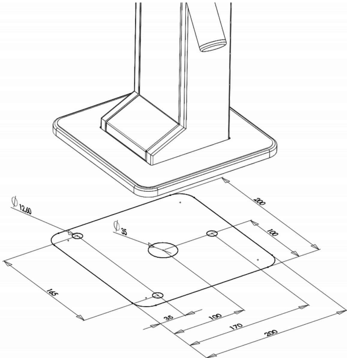
Рисунок 15 – Расположение монтажных отверстий относительно внешних габаритов турникета
