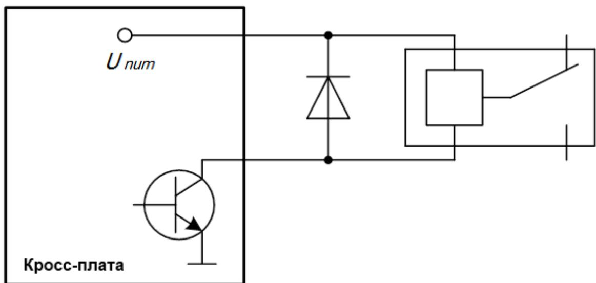
Рисунок 13 – Схема подключения диода параллельно обмотке реле
