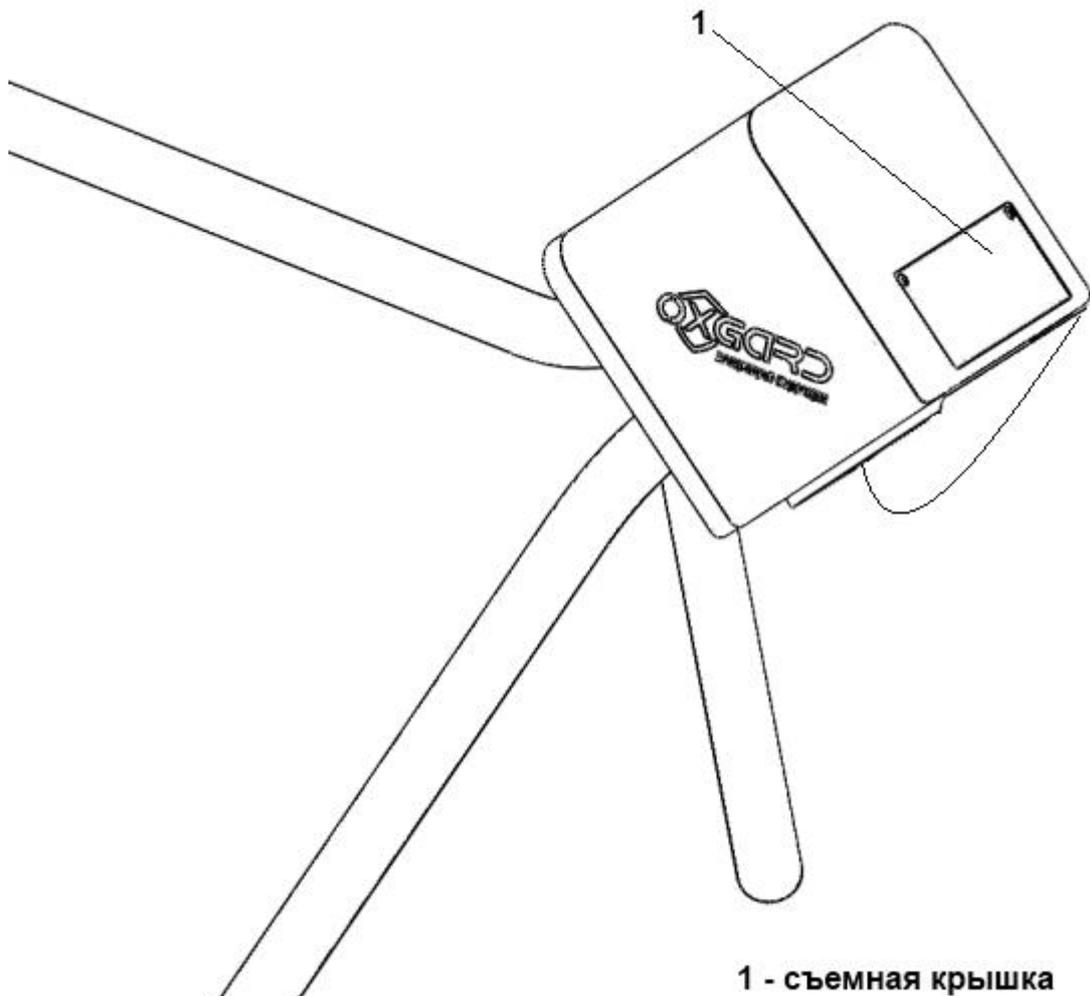
Рисунок 7 – Расположение кросс-платы под съемной крышкой
