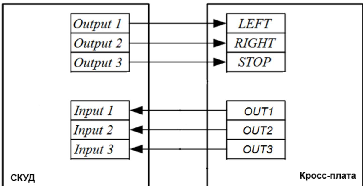
Рисунок 14 – Схема подключения ПУ к контроллеру СКУД
