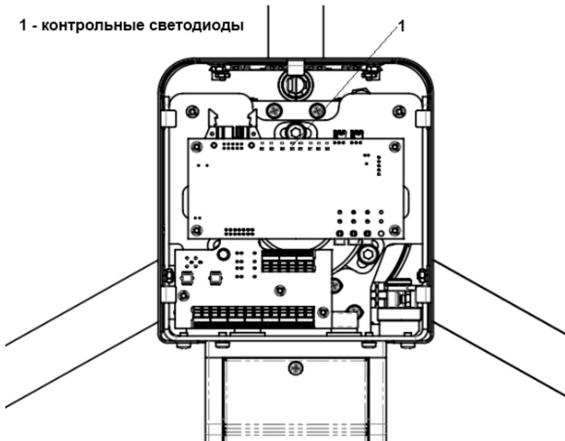
Рисунок 11 – Расположение контрольных светодиодов на материнской плате
