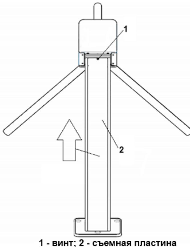
Рисунок 5 – Демонтаж съемной пластины стойки турникета
